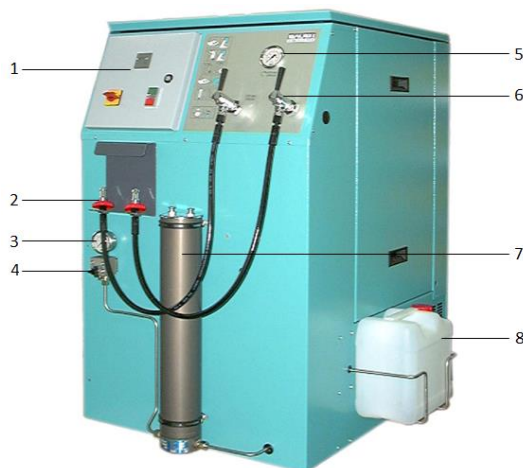
Рис. 1 Компрессорная установка высокого давления, модель серии MV 1-приборная панель, электрическое управление; 2-наполнительный штуцер; 3-манометр, выпускной клапан; 4-выпускной клапан, центральный фильтр; 5-манометр конечного давления; 6-наполнительный вентиль; 7-центральный фильтр P41/P61; 8-емкость для сбора конденсата.
