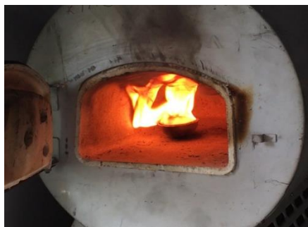
Рис. 12 – Вспышка при нагревании полиуретана с дизельным топливом при t = 350^\circ\text{C}
