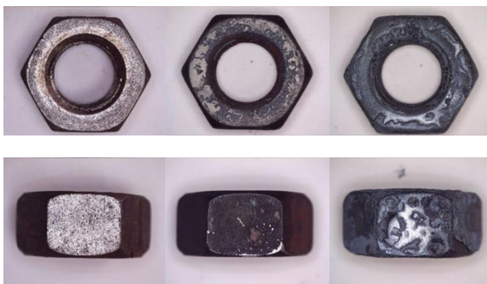
Рис. 1. Гайка стальная, выдержанная при температуре 200 °С, 700 °С, 1100 °С в течении 30 мин (при увеличении 11,83х)
